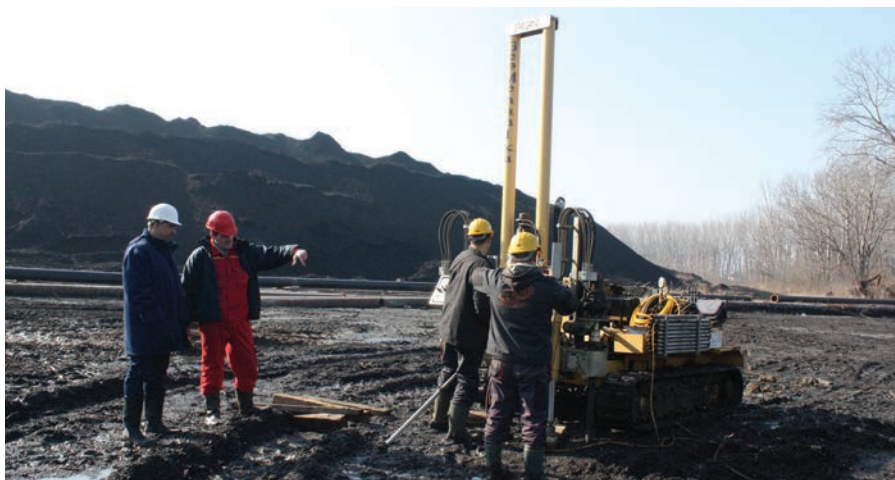
Извођење бушотина за опит статичке пенетрације ЦПТ, на локацији бу- дућих силоса за пепео и шљаку
