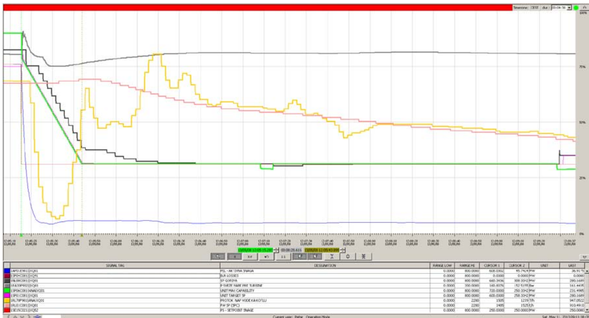
Слика 4.2: Параметри котловске регулације при растеређењу
