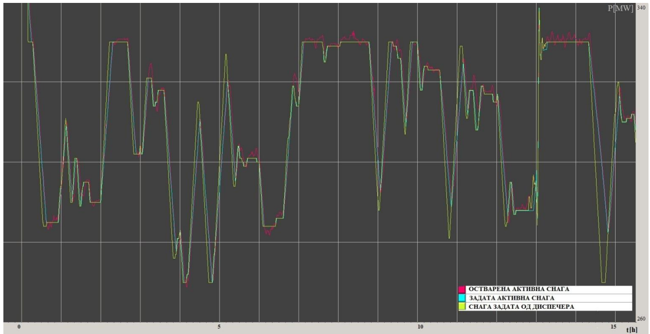
Слика 2: Пробни реални рад блока А5 у систему секундарне регулације
