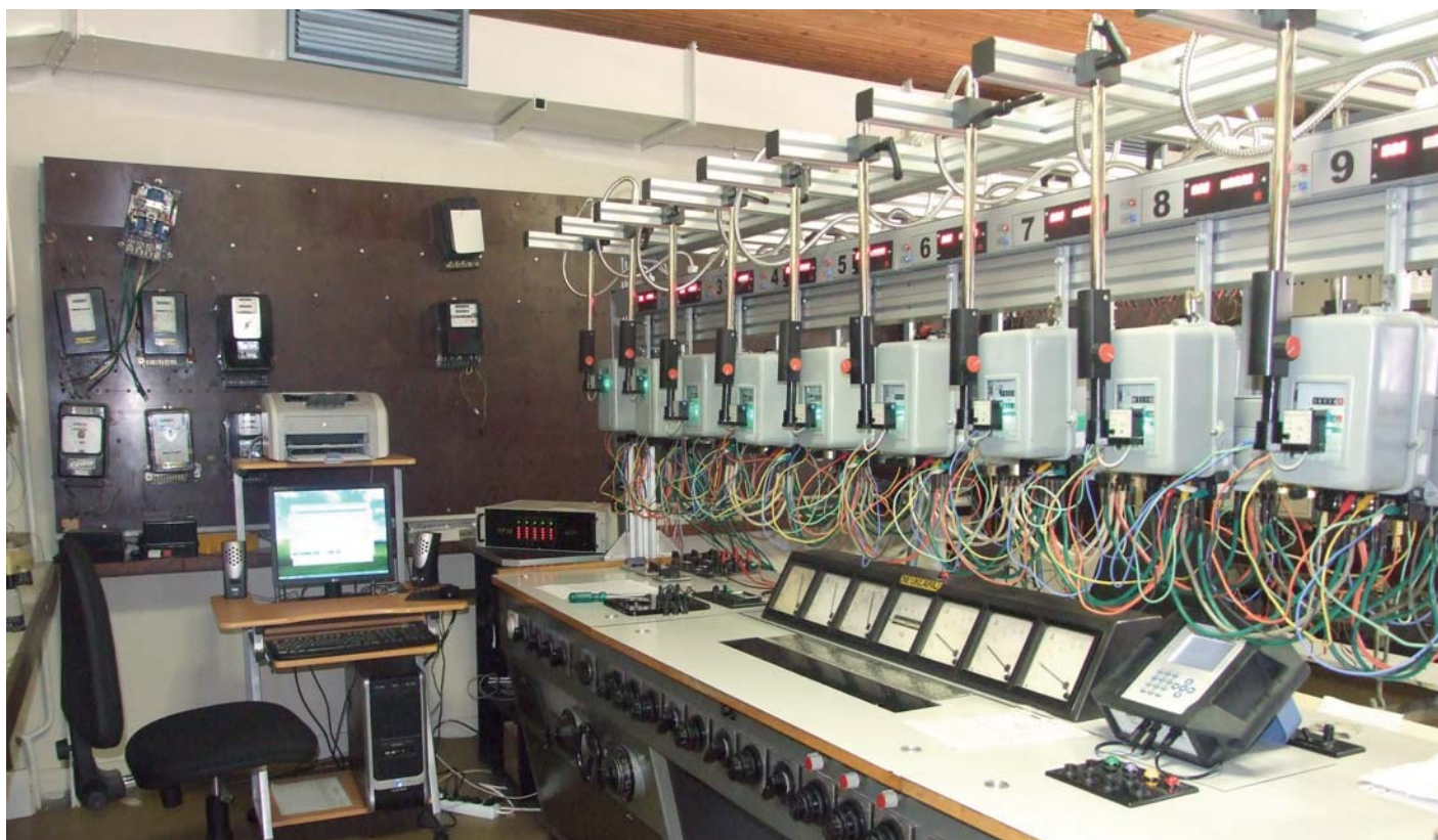
Баждарница у Пожаревцу способна да истовремено испитује 20 бројила
