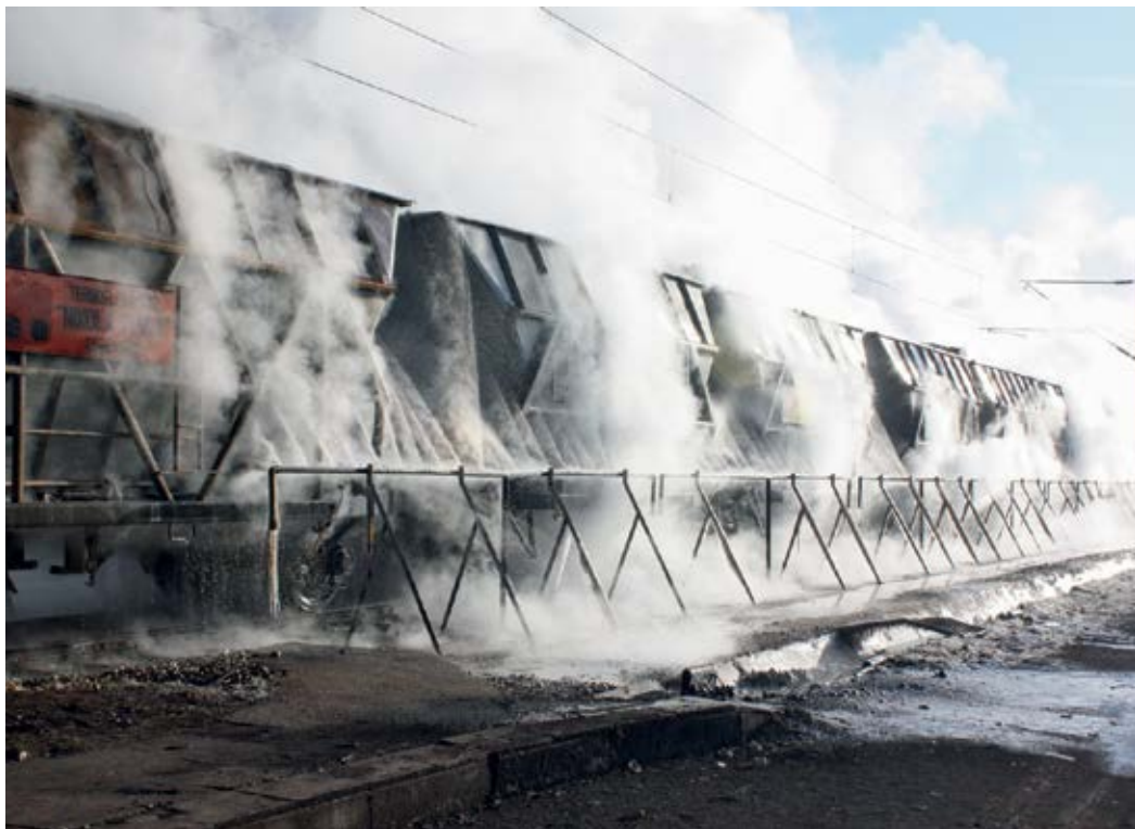
■ Вагони са угљем који пристиже у ТЕНТ, превентивно се одмрзавају воденом паром, како би се спречило да дође до застоја
