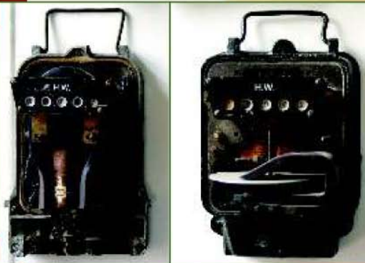
Први струјомери из времена када се потрошња електричне енергије мерила -хектоватсатима
