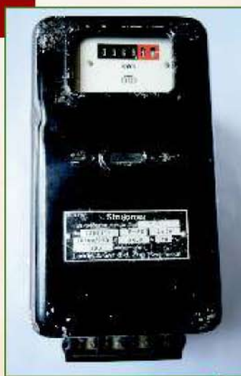
Све је записано: киловатсат; власништво ДТО; година: 1934; произвођач: Landis & Gyr d.d. Zug
