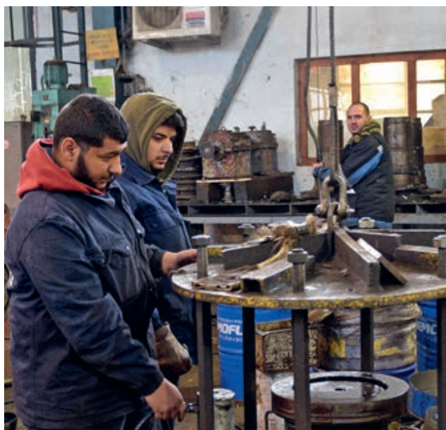
■ Ученици на ремонту редуктора трачног транспортера
