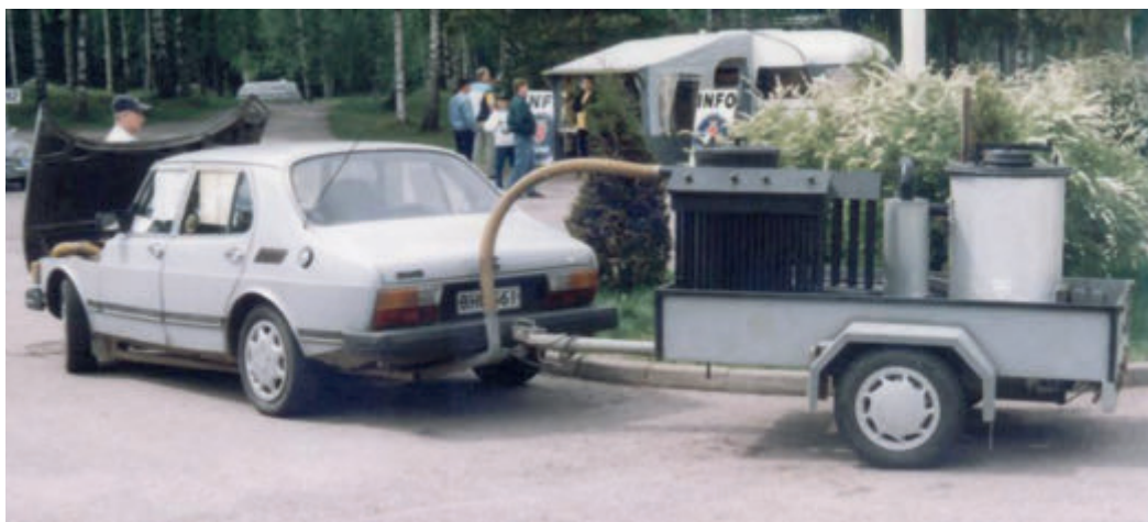
■ Аутомобил Сааб 99 с погоном на дрвну биомасу, снимљен у Финској
