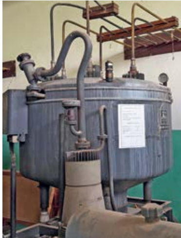
■ Живин исправљач прописно обележен налепницом за опасан отпад
