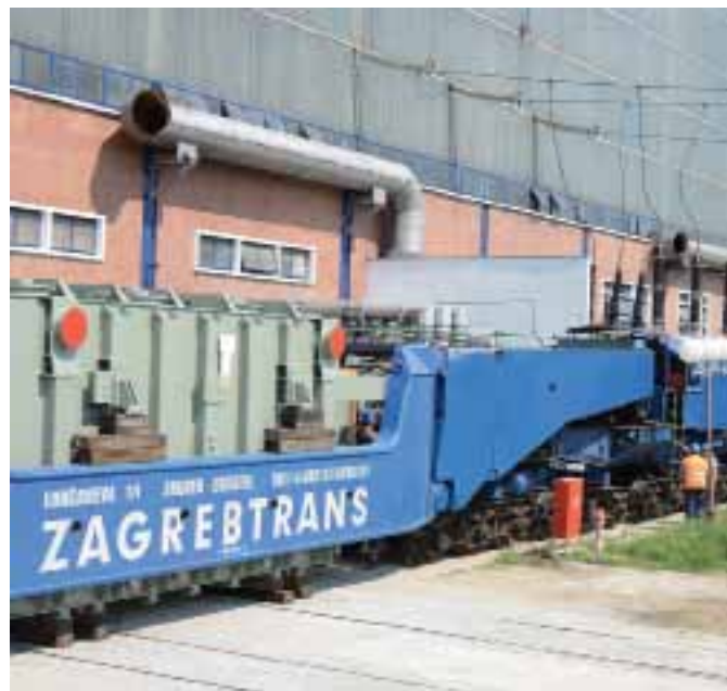
Укупна тежина трансформатора је 260 тона
