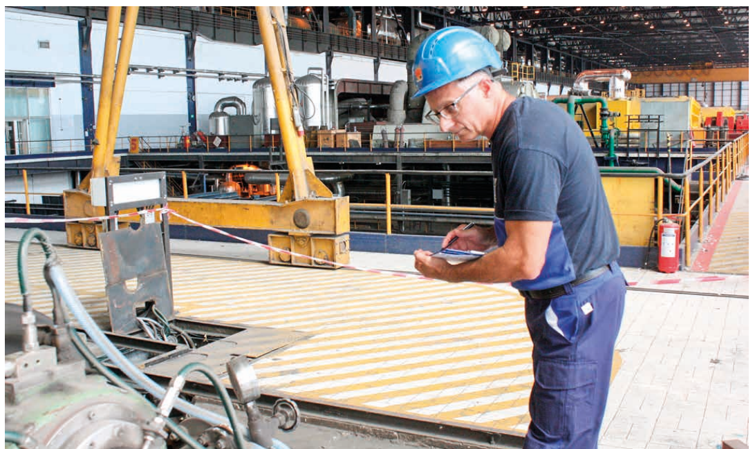
■ Испитивање вибрације на делу турбине
