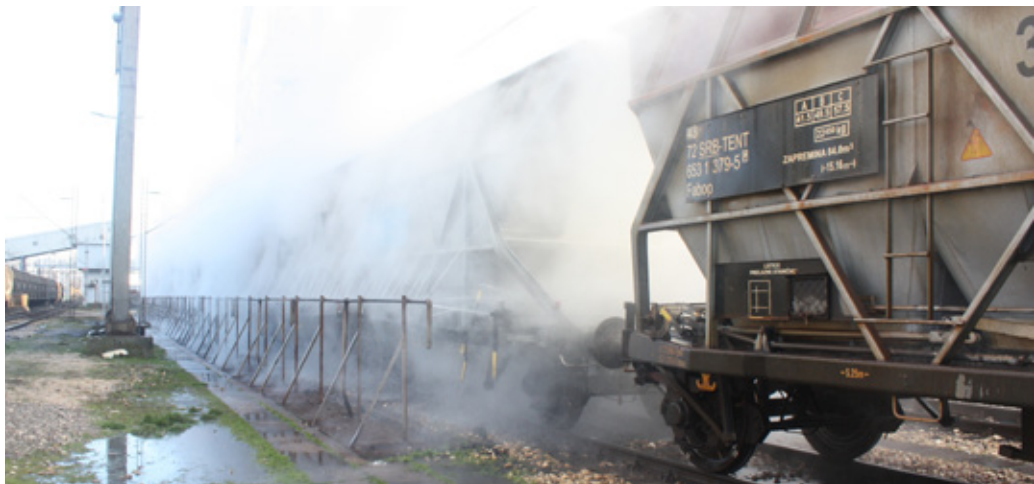
■ Постројење за одмрзавање радило пуном паром у фебруару
