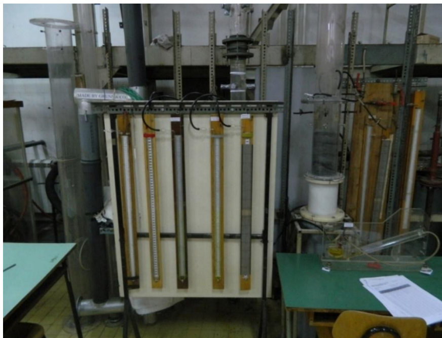
Slika 3 Instalacija korišćena za ispitivanje fluidizacionih karakteristika nasutog sloja uzorka pepela
